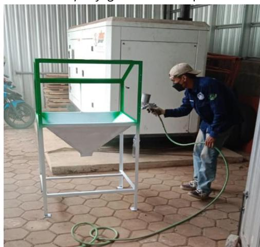
Gambar 6. Proses Pengecatan
